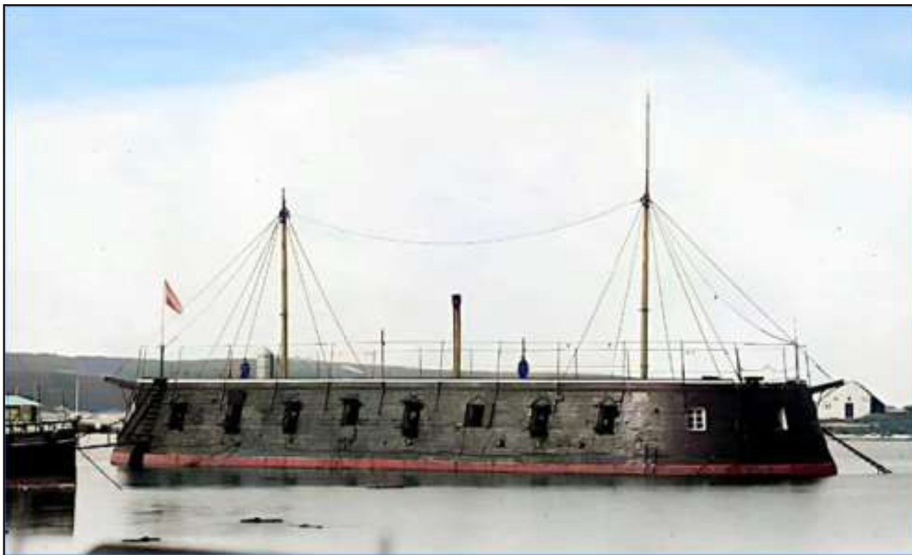
Il Feuerspeier, oramai non più Erzherzog Friedrich, dopo il 1908 trasformato in nave alloggio per gli allievi della Scuola di Artiglieria di Pola; l'alberatura ha lasciato posto a una utilizzabile per le segnalazioni ottiche mentre le macchine sono state rimosse, data la sparizione del fumaiolo, rimosso per lasciare posto ai servizi ausiliari.
