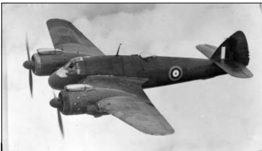
Un bimotore britannico Bristol Beaufighter: il suo armamento di quattro canoni da 20 mm e quattro mitragliatrici da 7,7, oltre a quello di caduta che poteva comprendere bombe, razzi o siluri, gli avevano fatto meritare il soprannome di "Wispering Death", morte sussurrante.
