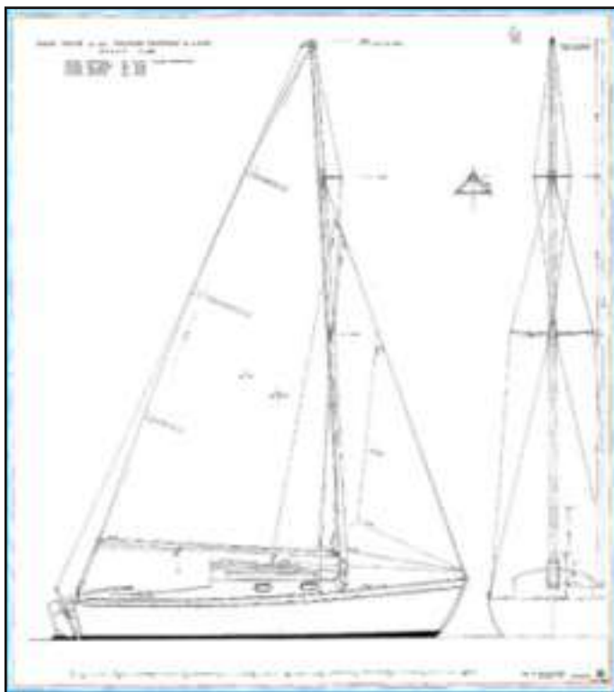
Foto 5. Profilo e piano velico di una passera triestina di 6.5 metri.
