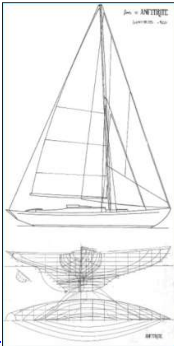
Foto 9. Piano di costruzione e piano velico di Anfitride
