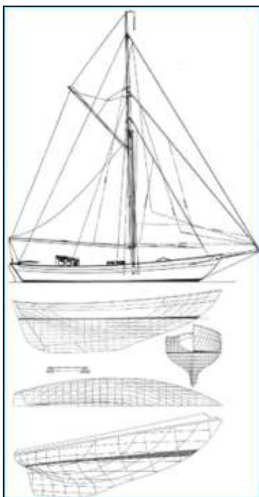
Foto 13. Piano di costruzione e modello tridimensionale dello scafo del "Dyarchy".
