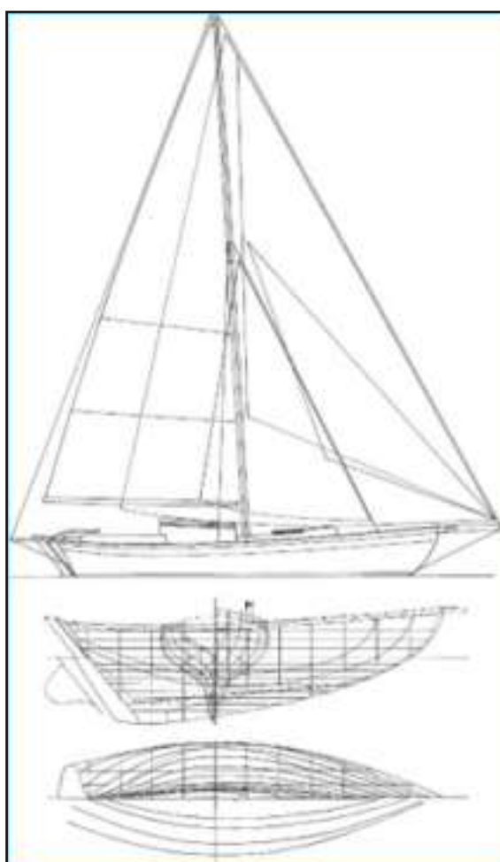
Foto 13. Piano di costruzione e modello tridimensionale dello scafo del "Dyarchy".
