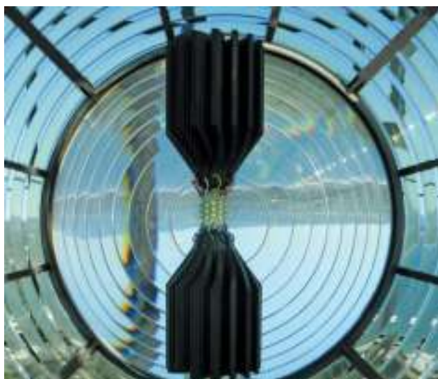
sorgente luminosa a LED in una lente di fresnel
