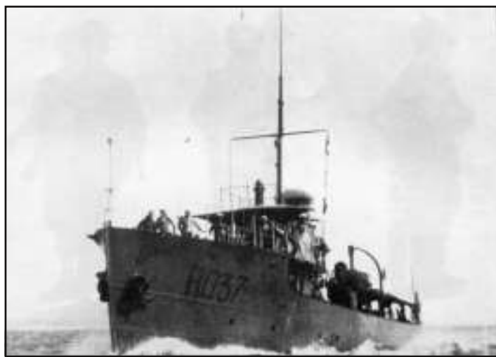
Foto 6 - Un'immagine dell'RD 37, gemello del 36, in navigazione, ripresa, probabilmente, appena l'unità era entrata in servizio ma non era ancora stata ultimata, dal momento che non sono visibili né il cannone né le due mitragliatrici poste sulla tuga.
