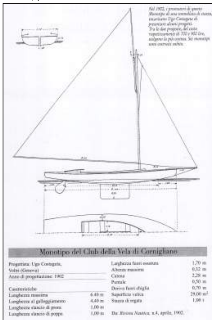
Foto 1 - Il piano del monotipo progettato da Attilio Costaguta per il Club della Vela di Cornigliano tratto dalla "Rivista Nautica" Aprile 1902
