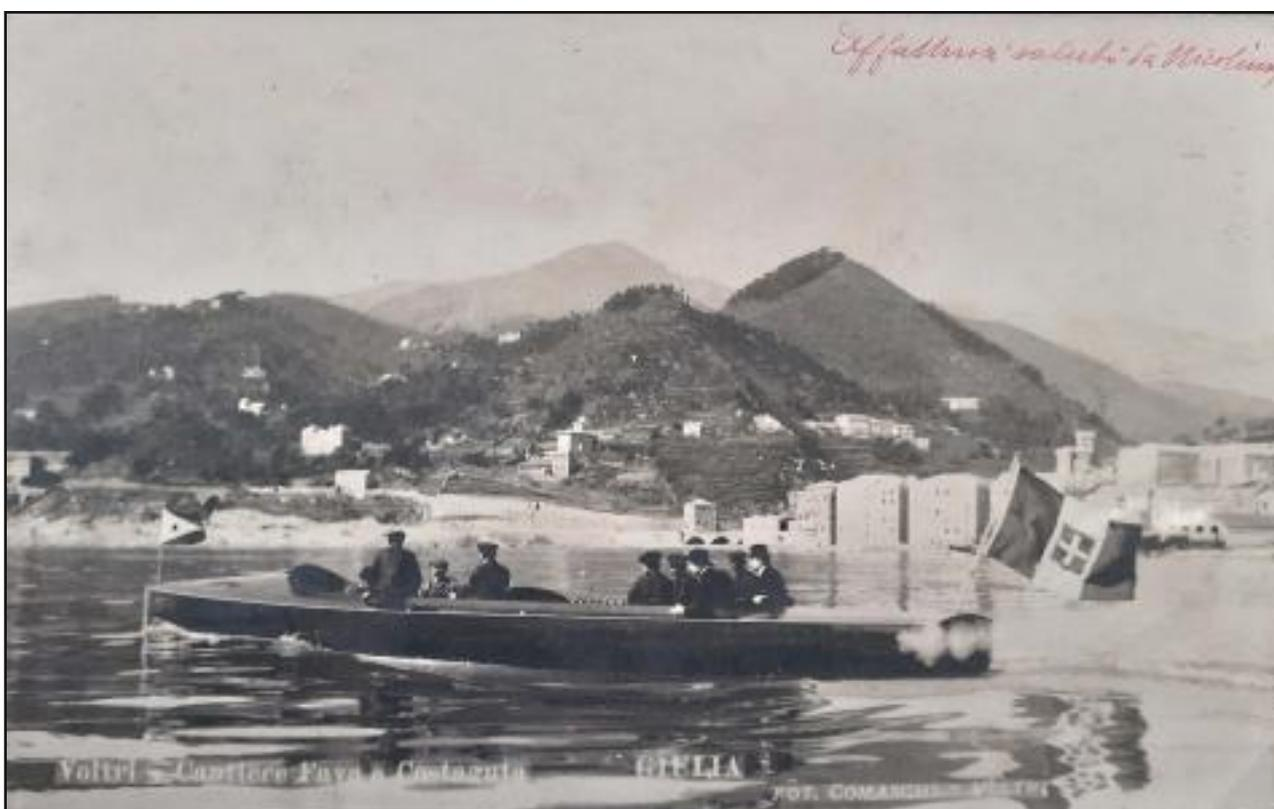
*(foto 3) – Foto 1-2-3: Primavera 1901 Ivaro della motolancia “Giulia” per il Cav. Ugo Eurietti costruita in mogano con prua a cutter e poppa a specchio, verniciata di aspetto molto elegante, venne esposta alla Esposizione et concours de Canot Automobile di Montecarlo riscuotendo grande apprezzamento.*
