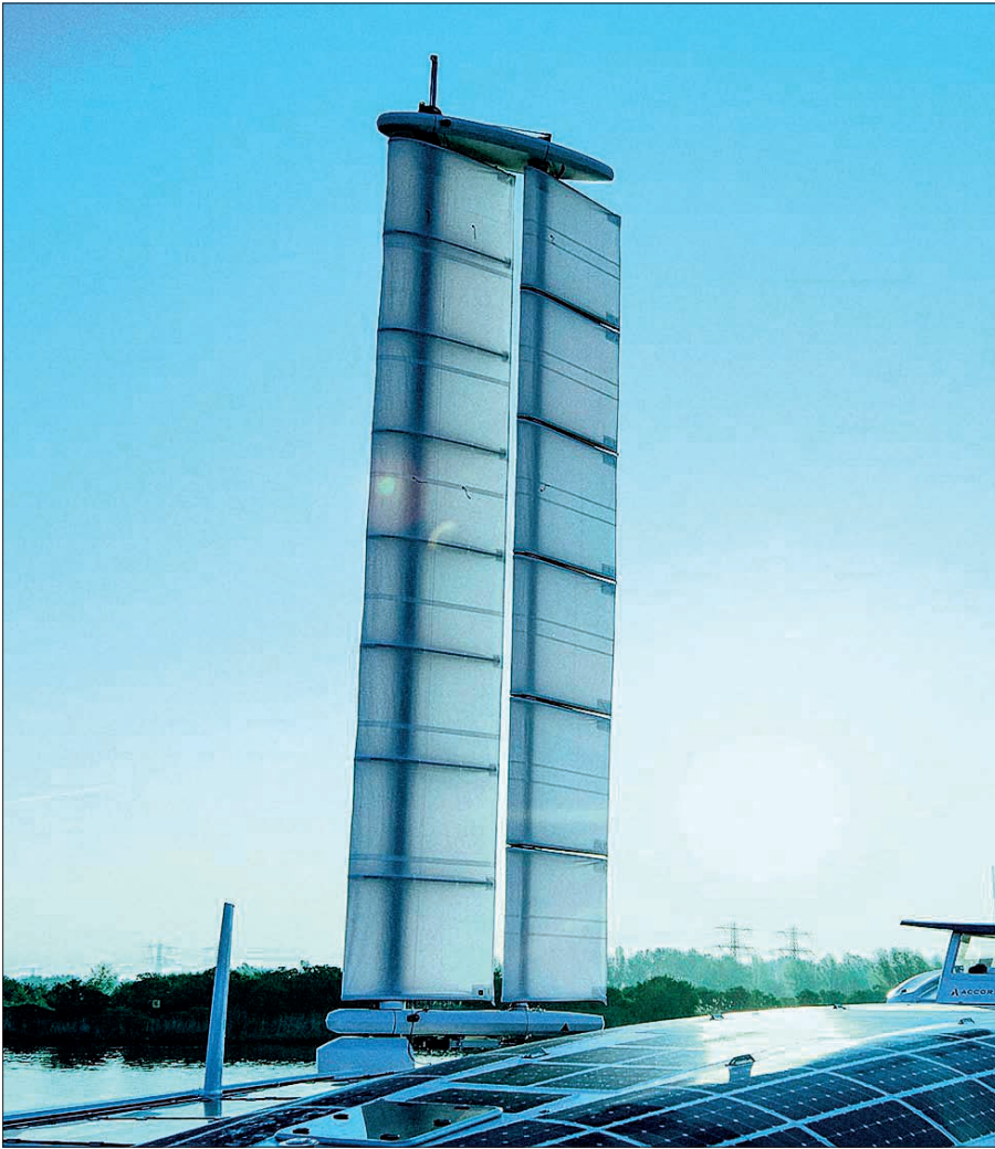
Il sistema di propulsione ausiliaria eolica OceanWings montato a bordo del catamarano Energy Observer
