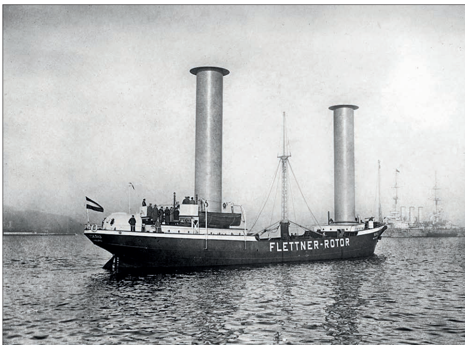
La nave tedesca Baden Baden (già Buckau ), qui in un'immagine del 1924, nel 1925 attraversò l'Atlantico dotata di una vela a rotore tipo Flettner
