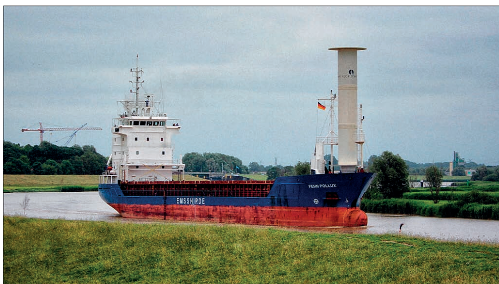
La nave da carico Fehn Pollux dopo l'installazione di un Eco Flettner rotor sail nel 2018 è stata sottoposta ad una serie di prove per misurare le prestazioni del sistema
