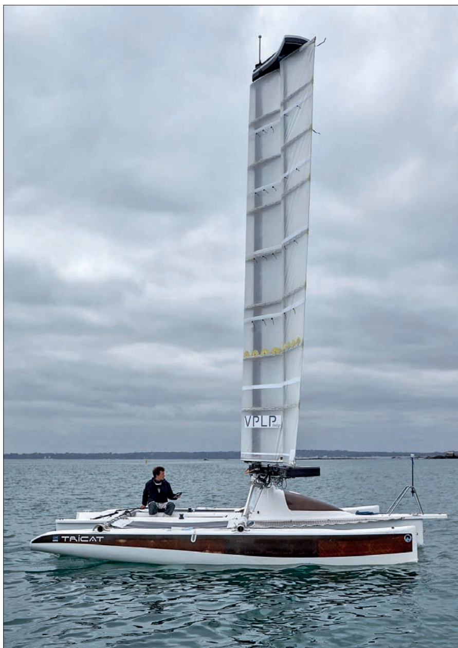
Un prototipo del sistema di propulsione ausiliaria eolica OceanWings montato su di una barca da diporto con scafo a trimarano
