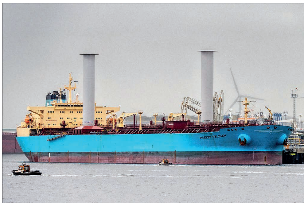
La nave portacontaineri Maersk Pelican , qui ripresa nel 2018, è dotata del più grande rotore Flettner esistente
