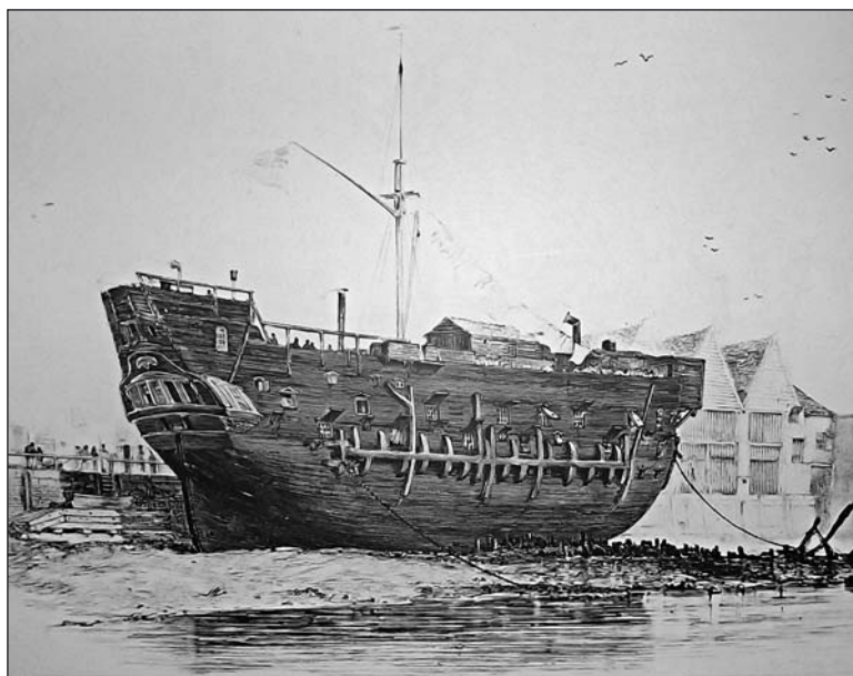
Una nave prigioniera a Jersey, sulla Manica: notare le tettoie e i condotti per il fumo delle stufe installati dopo aver disalberato la nave
