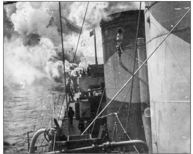
Il Sella in funzione anti sommergibile: a sinistra la poppa della nave e le tramogge da cui verranno scaricate le bombe anti sommergibile; sopra le colonne d'acqua generate dagli ordigni
