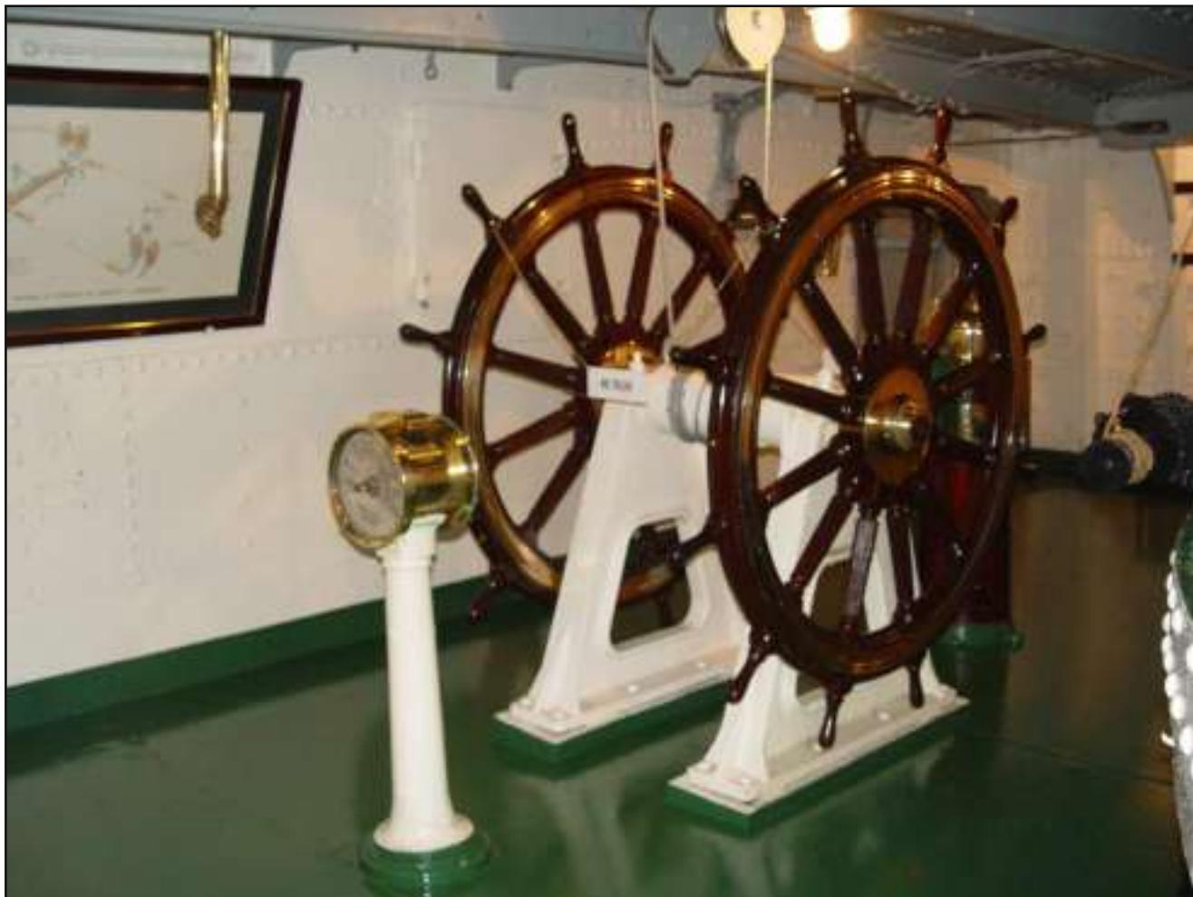
La ruota del timone, il telegrafo di macchina e un portavoce nella plancia comando corazzata dello "Huascar".
