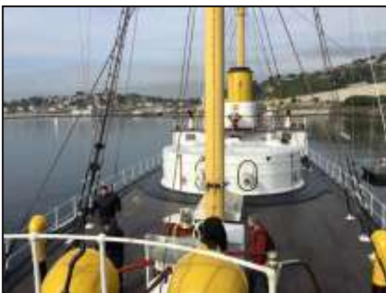
- La torre dei cannoni di grosso calibro sul ponte dell'unità; notare dietro la torre e prima del fumaiolo il ridottino corazzato per dirigere la nave da posizione esterna alla plancia.
